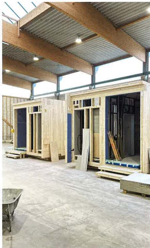
Einheben eines vorgefertigten Holzmoduls auf der Baustelle des AKH Wien und fertige Raummodule im steirischen Werk, bereit für den Transport. Lifting a prefabricated timber module onto the construction site of the AKH Vienna and room modules at the Styrian factory, ready for transport.
