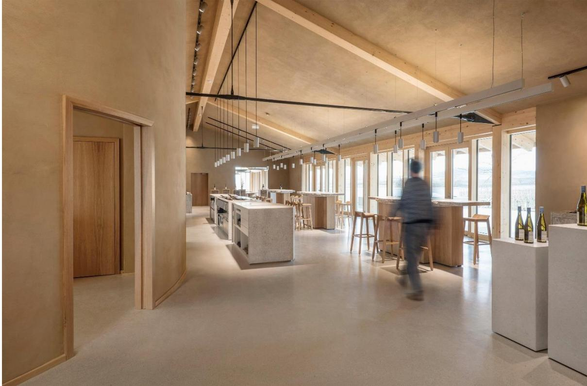
The new place to be: Der Verkostungsraum unter einer Holzkonstruktion mit Satteldach und Lehmkühldecke (Foto: Hertha Hurnaus)
